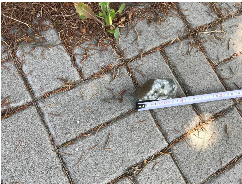
Obr.4 – Vývrt V2, šikmý konec vývrtu \sim 45^\circ (pravděpodobně úklon rubu křídla)
