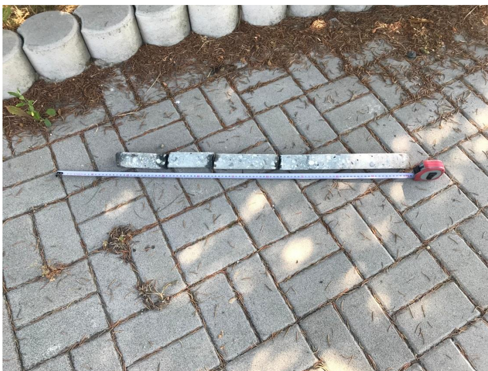
Obr.2 – Vývrt V1, ztráta části jádra, nedosaženo konce zdiva, L=1,00m
