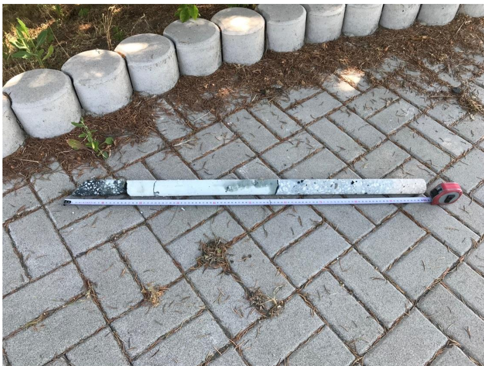
Obr.5 – Vývrt V3, dosaženo konce zdiva, L=1,00m , konec šikmý 45°.
