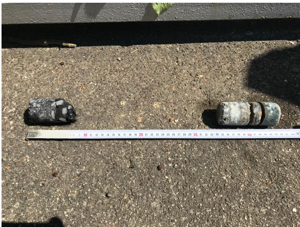
Obr.6 – Vývrt V4, vozovka, část jádra odplavena výplachem (písek), živé vrstvy ~80mm, beton ~ 100mm
