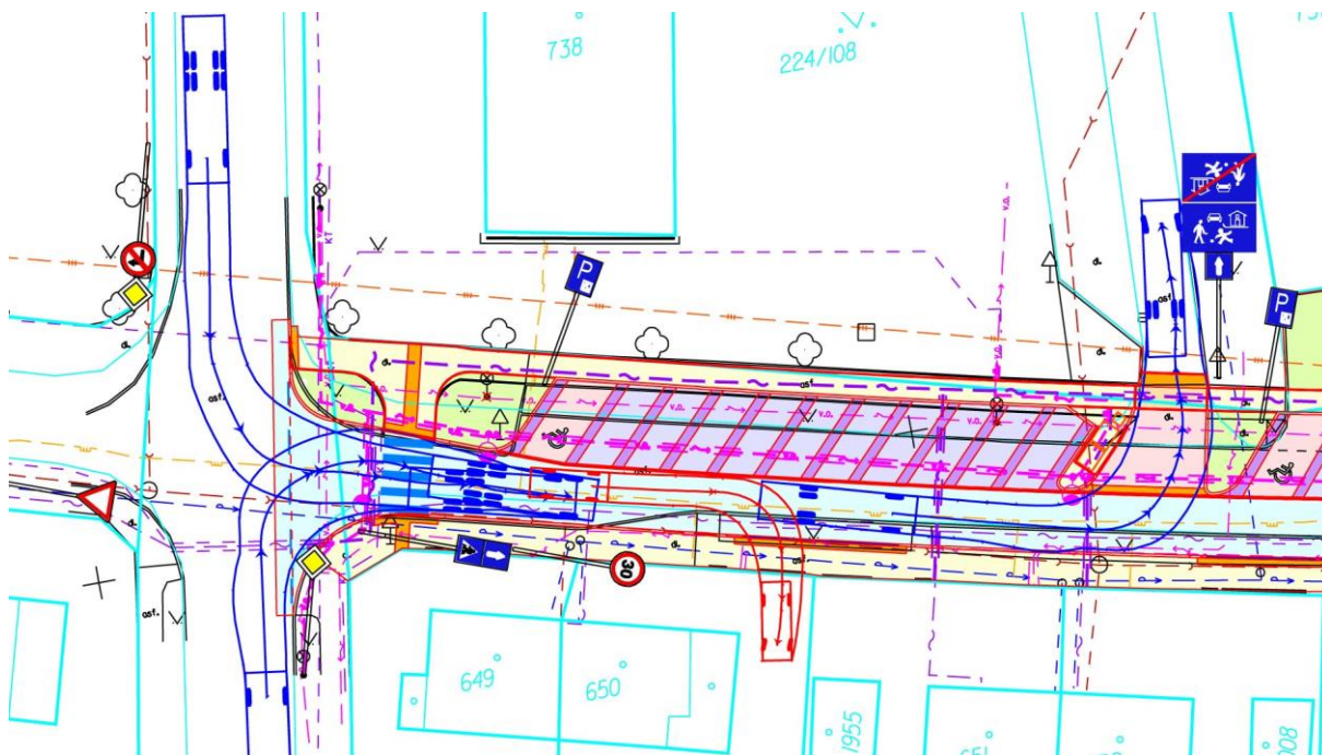
Obr. č. 2 – Trajektorie návrhového vozidla N2 střed:
